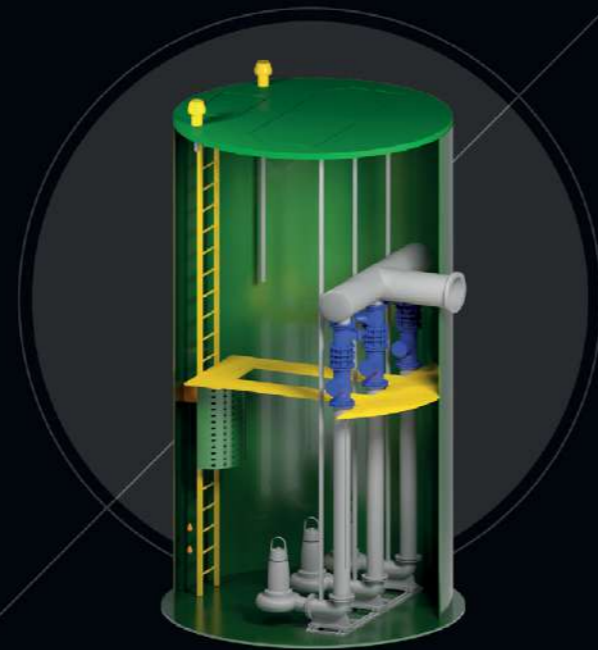
Канализационные насосные станции
